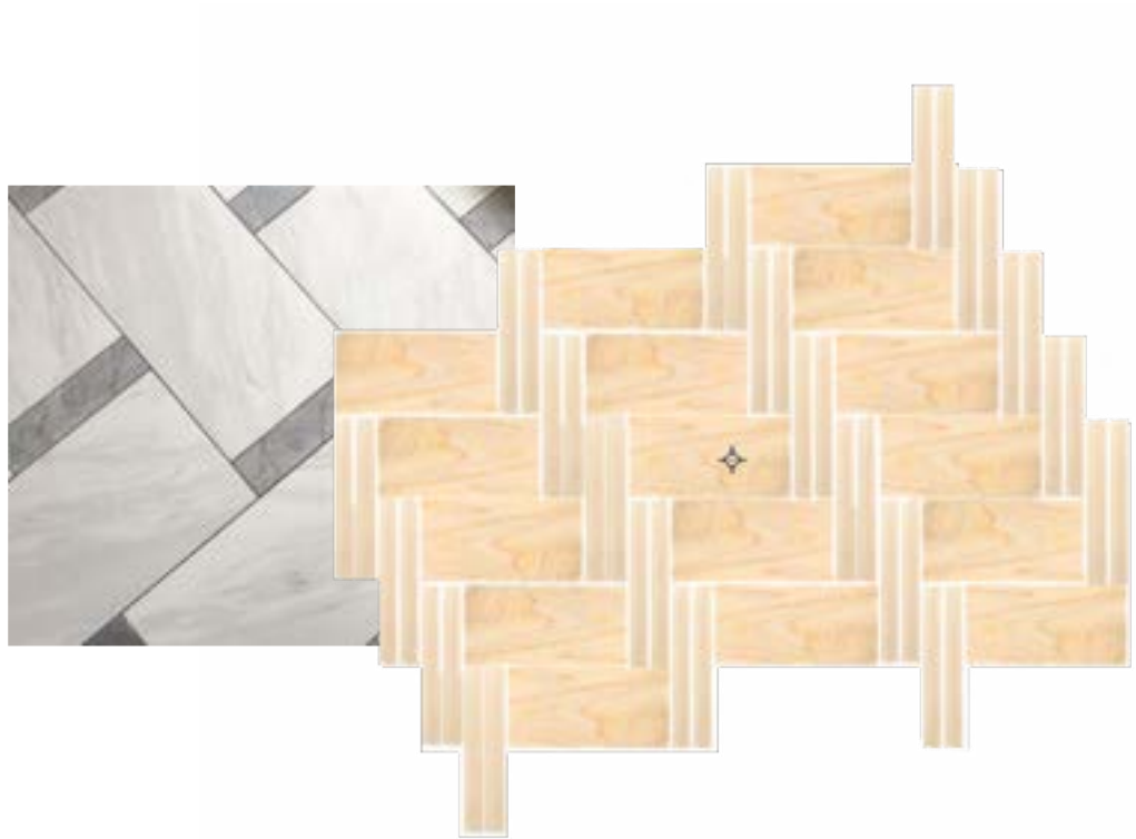
石材タイルで用いられる幾何学模様の建材ユニット building material unit often used in geometric patterned stone tiles
